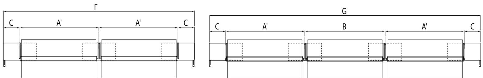
N.B. GLI INTERASSI SONO DIVERSI A SECONDA DEI PALI UTILIZZATI. NOTARE CHE IL CASO CON NR. 3 FLEXY RICHIEDE UN INTERASSE B PERCHÈ IL FLEXY CENTRALE È SORRETTO DA NR. 2 PALI DOPPI MENTRE I FLEXY AI LATI SONO SORRETTI DA NR. 1 PALO LATERALE.
